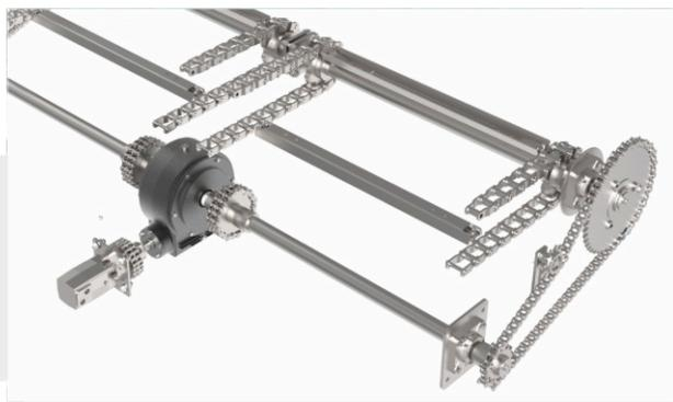
Sistema de descarga comandado por un robusto reductor de sinfín-corona accionado por un motor hidráulico de alto torque, desde el cual salen dos ejes para transmitir el accionamiento independiente de cada uno de los ramales de la cadena acarreadora de forraje.
