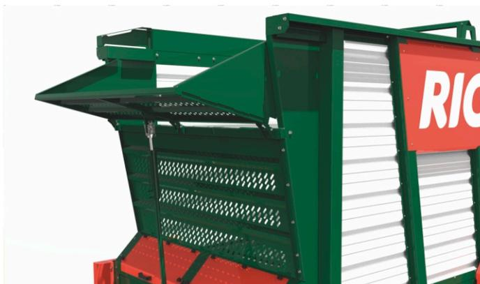
Sobre baranda lateral desmontable de 200 mm
