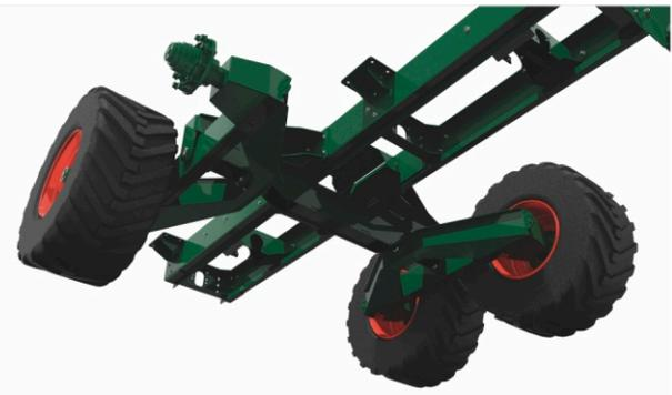
Balancín angosto con las ruedas por debajo de la caja de carga. Menor rango de oscilación de los balancines. Ancho máximo de transporte 2800mm. Rodado 600/55 R26.5
